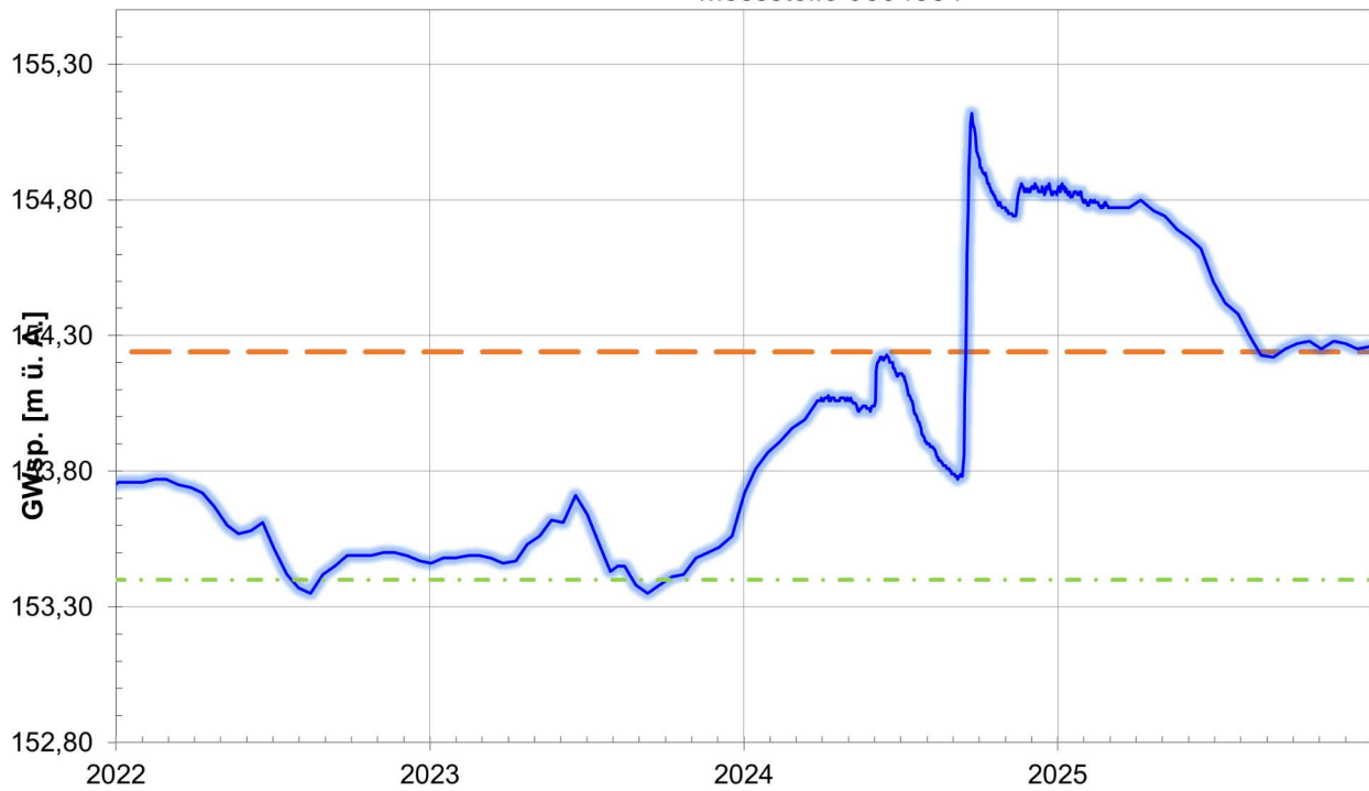
Abbildung: Entwicklung des Grundwasserstands an der Messstelle Deutsch-Wagram der letzten vier Jahre mit der Darstellung der mittleren Grundwasserstände der Jahre 1966-2015 (orange Linie) und der Einschalthöhe der Grundwasseranreicherung (grüne Linie)
