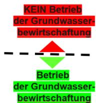
Die Ganmlinie (Bild oben) des Grundwasserstandes zeigt schematisch, wann der Betrieb möglich ist. Bei steigendem Grundwasser muss der Betrieb wieder eingestellt werden.
